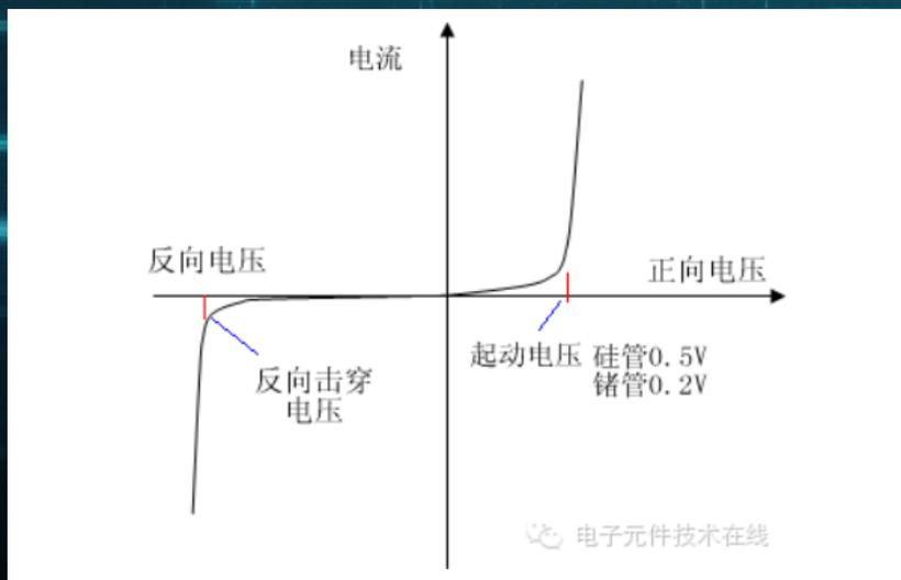
由P区引出的电极称为阳极，N区引出的电极称为阴极。因为PN结的单向导电性，二极管导通时电流方向是由阳极通过管子内部流向阴极。当PN结电压 $>0.5\text{V}$ 时，二极管导通 否则截止。
